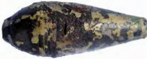
Granate aus dem Thunersee mit Korrosionserscheinungen, die auf das Explosionsunglück Mitholz zurückzuführen sind.
