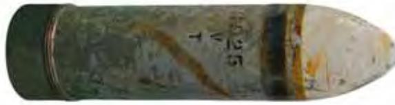
12-cm-Granate aus dem Vierwaldstättersee. Die Korrosionsspuren stammen vom Hebevorgang.
